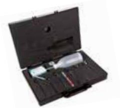
6 Eindringprüfung, Karsten Pipe-Testkit
