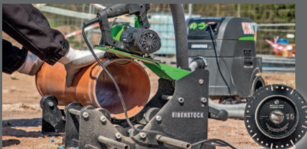
Schneiden und Fasen in einem Arbeitsgang
